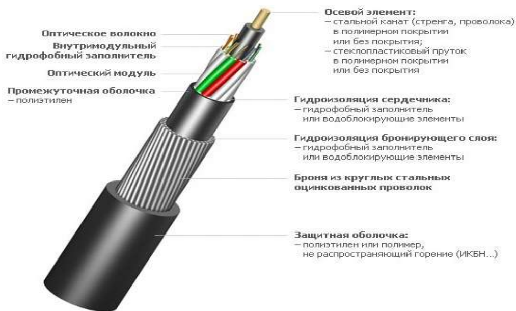
Рисунок 1, Подземный оптический кабель для укладки в грунт
