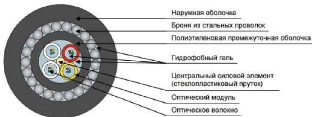
Рисунок 2, Подземный кабель для укладки в кабельную канализацию
